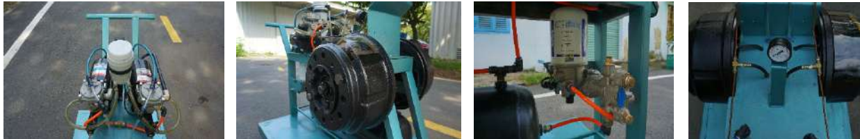
Hình 5. Bộ chấp hành thủy khí, cơ cấu phanh, bộ lọc khí nén và bố trí các đường dây khí nén trên mô hình.
