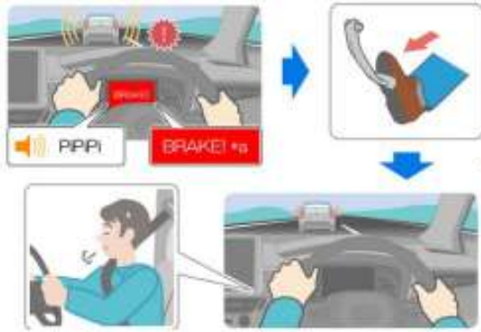
Hình 25. Chuông thông báo của PCS sẽ tắt khi khoảng cách giữa 2 xe an toàn.
