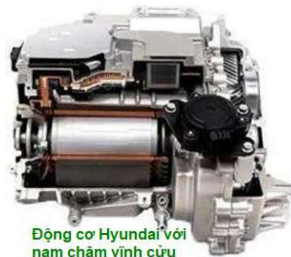
Hình 6. Động cơ điện nam châm vĩnh cửu trên xe Hyundai IONIQ
