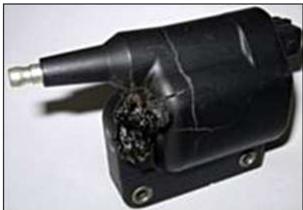
Hình 1. Bobine bị cháy vì thời gian ngâm quá dài
