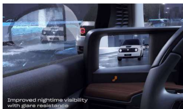
Hình 3. Hình ảnh từ camera truyền về màn hình
