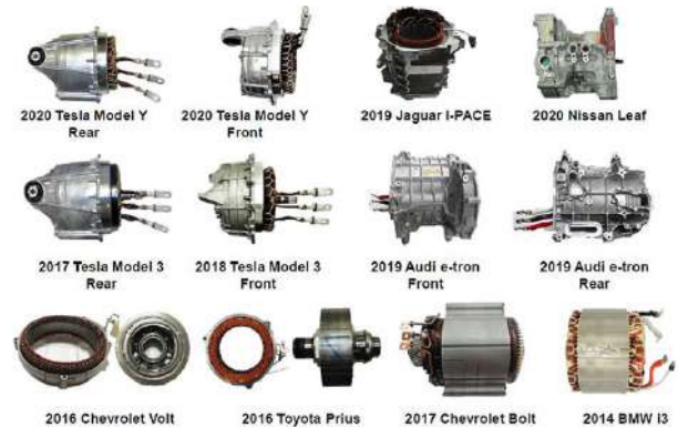
Hình 3. Các loại động cơ trên ô tô điện và hybrid
