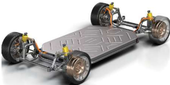
Hình 2. Motor được lắp trong bánh xe
