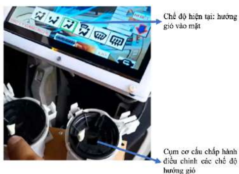
Hình 3. Cơ cấu chấp hành được điều khiển vị trí gió thổi vào mặt
