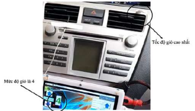
Hình 6. Cơ cấu chấp hành điều khiển quạt mức độ 4(HIGH)
