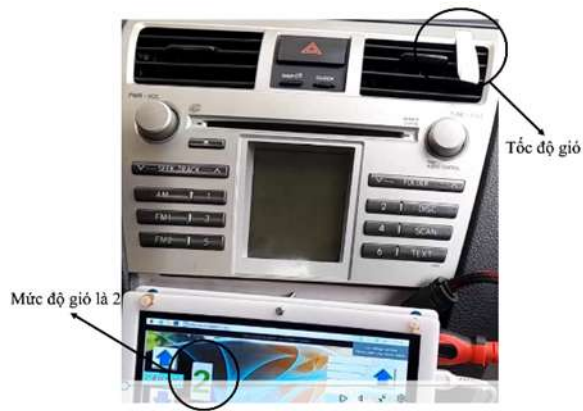
Hình 5. Cơ cấu chấp hành điều khiển quạt mức độ 2
