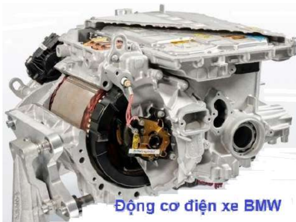
Hình 8. Động cơ BMW loại đồng bộ kích từ bằng điện
